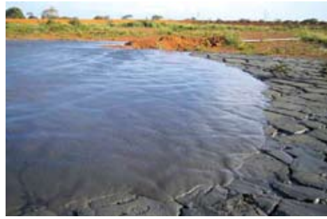
Pembuangan tailing pasta di permukaan
