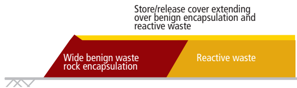
图 3：用良性物质密封易发生反应的废矿石
